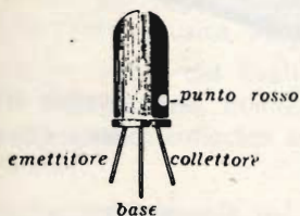
Fig. 8 - Indicazione della posizione degli elettrodi del transistor OC 71.
